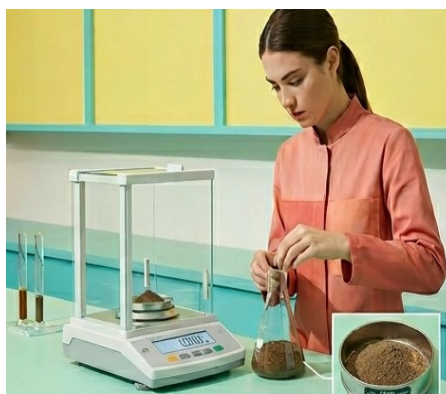
المرحلة 1: وزن 1.000 جرام من عينة التربة الجافة (حجم الحبيبات 0.25 مم).
