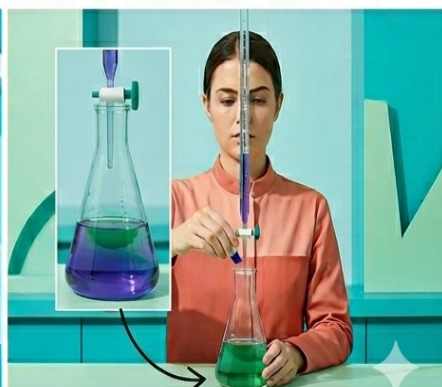
المرحلة 6: المعايرة بمحلول كبريتات الحديدك الثنائية حتى نقطة النهاية (تغير اللون).
