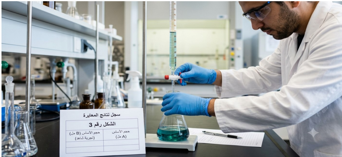
الشكل رقم(3): مرحلة المعايرة في تجربة تقدير محتوى النبات من النتروجين.
