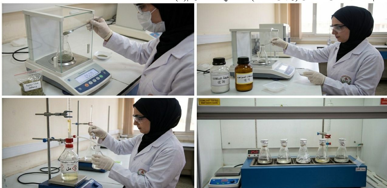
الشكل رقم (1) : هضم العينات النباتية لتقدير النتروجين الكلي
