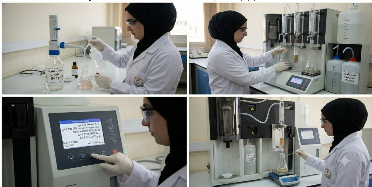
الشكل رقم(2): طريقة تقطير العينات النباتية لتقدير النتروجين الكلي
