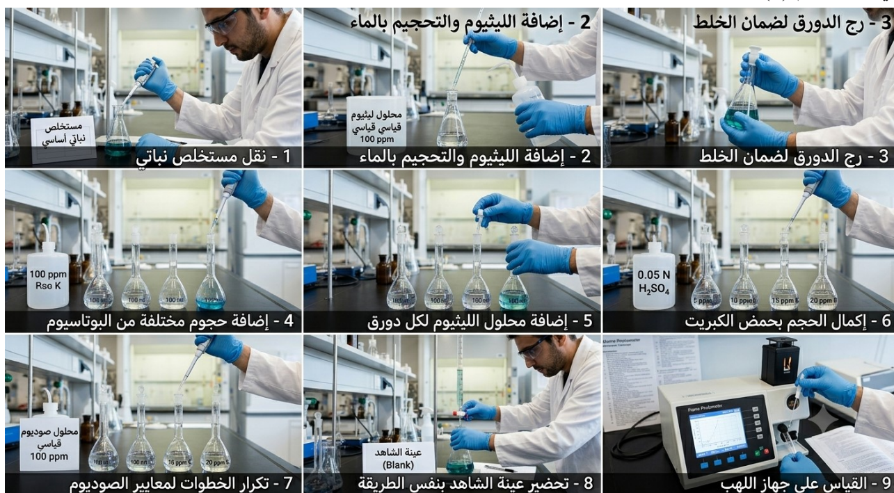
الشكل رقم(5): طريقة تقدير البوتاسيوم في النبات
