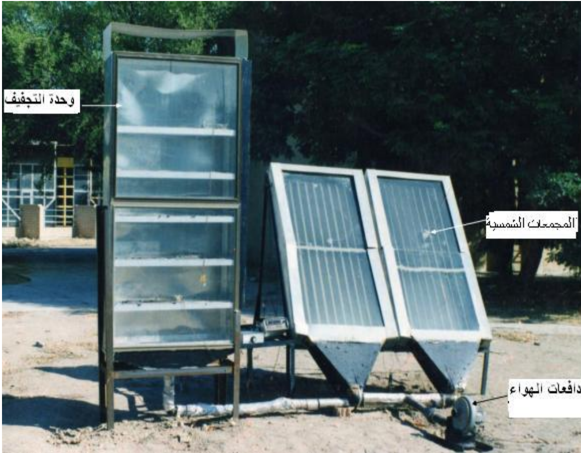
الشكل (٥) مجفف شمسي لتجفيف المحاصيل الزراعية
