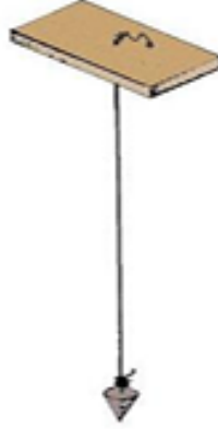
الشكل (3-9) الشاقول - ثقل مخروطي بطرف الخيط
