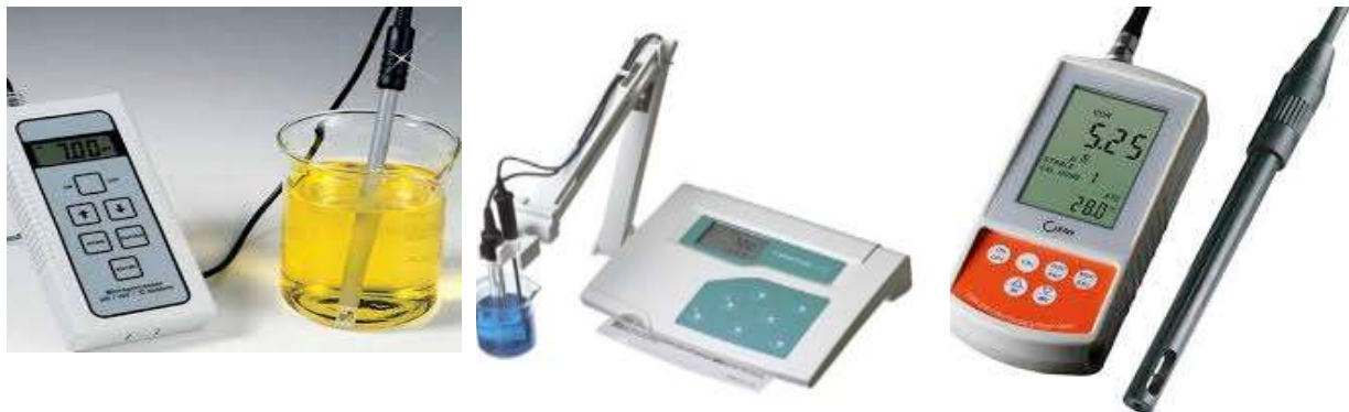
الشكل رقم (3): أشكال مختلفة من أجهزة قياس الـ pH
