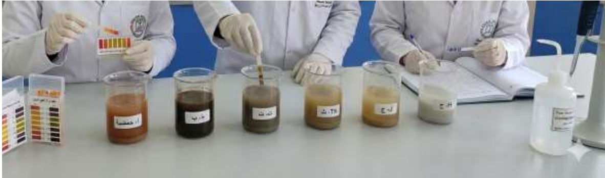
الشكل رقم (2) طريقة قياس درجة تفاعل التربة الـ(pH) بالشرائط المدرجة الملونة.
